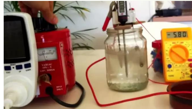
Électrolyse de l'eau lourde D_2O avec des électrodes de palladium
