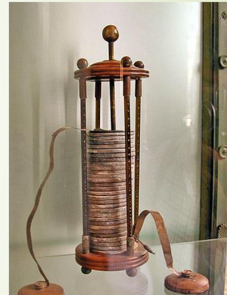
Pile de Volta (circa 1800) : zinc et cuivre séparés par feutre imbibé de saumure
